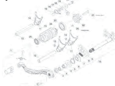
TAV.05 Comando cambio - Gear shift control - Commande changement de vitesse - Chaltung - Mando cambio
