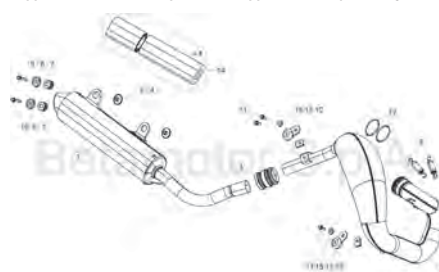
TAV.37 Gruppo scarico - Exhaust system - Echappement - Auspuffanlage - Grupo escape
