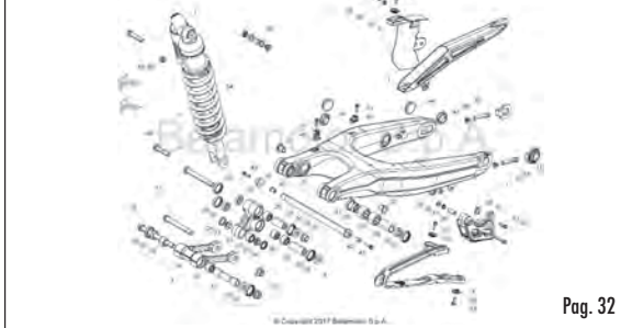
TAV.33 Forcellone posteriore - Rear fork - Fourche arriere - Hinterradschwinge - Horquilla posterior
