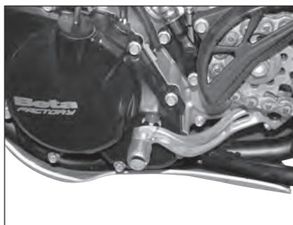
Pour le remplacement du filtre huile en papier dévisser les deux vis **E** pour le démontage du couvercle filtre huile, enlever le filtre par une mâchoire et élargir.
