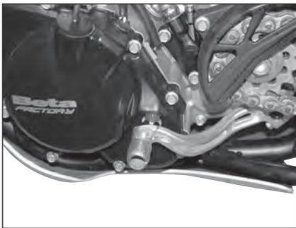
Um den Ölfilter zu wechseln, müssen die beiden Schrauben **E** und der Ölfilterdeckel entfernt werden. Mit einer Sicherungsringzange kann der Ölfilter aus dem Gehäuse gezogen werden.
