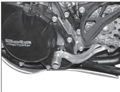
Per la sostituzione del filtro olio in carta svitare le due viti **E** per lo smontaggio del coperchio filtro olio e sfilare il filtro tramite pinza ad allargare.
